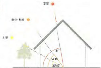
図1 季節によって日の高さはこんなにも違う。 軒の出や南側に落葉樹を植えたりすることで、冬の間は日室内に取り込み、夏の間は日を守るのがプランニングの原則です。
